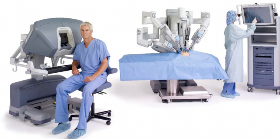
Figura 1.1 - I tre elementi fondamentali della piattaforma robotica
